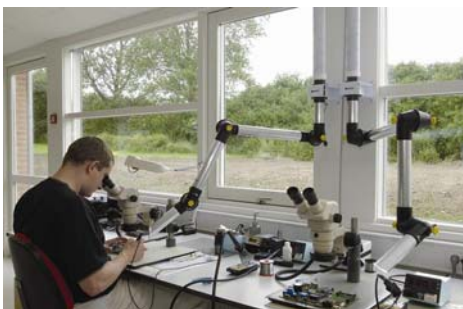
Arbejdsplads med 2 sugesteder på væg.
