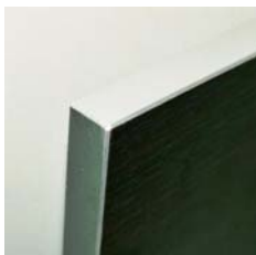
Skabslåge i 16mm spånplade, belagt med højtrykslaminat på begge sider med udvendig aluminiumskant.
